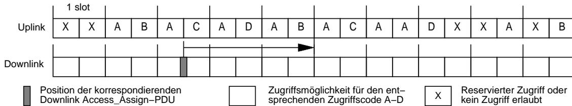
**Abbildung 2.24:** Zugriffsmethoden des V+D-Zufallszugriffsprotokolls
